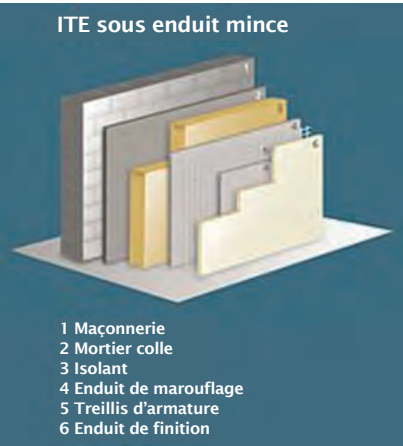
Principe d'isolation des murs
